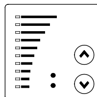
Fig. 13 Panel de control de una bomba TPE.
